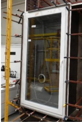
Phot.3 Intrusione di acqua attraverso l'angolo inferiore sinistro a pressione di prova 300 Pa
