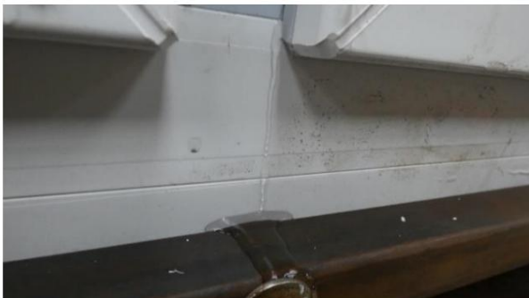
Phot.3 L'intrusione di acqua alla pressione di prova di 250 Pa, attraverso la linea di giunzione nell'angolo inferiore sinistro dell'anta destra
