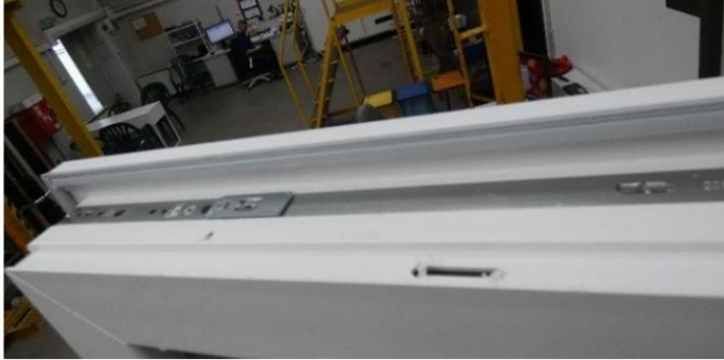
Foto 21 Sigillatura dell'angolo inferiore destro dell'anta centrale
