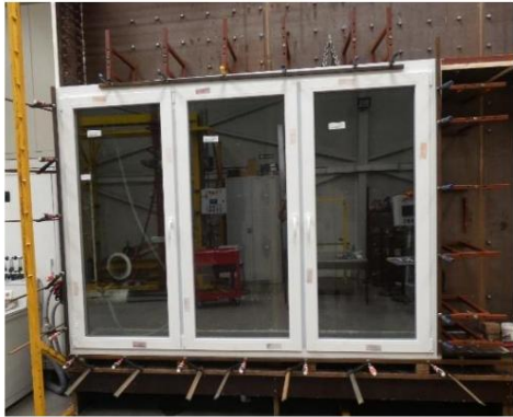
Phot.3 L'intrusione di acqua alla pressione di prova di 250 Pa, attraverso la linea di giunzione nell'angolo inferiore sinistro dell'anta destra
