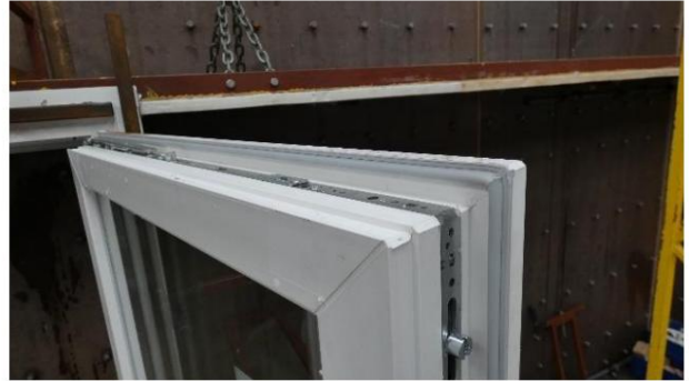
Foto.16 Soglia sezione telaio anta sinistro; guarnizioni, raccordi e fessure di drenaggio visibili
